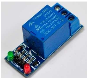
Fig : 4.4 RELAY MODULE
